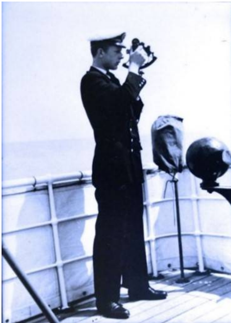
Figuur 4: Begin zestiger jaren. Zonshoogtemeting met een sextant door Gert Dop, toen nog leerling stuurman. Bron: auteur
