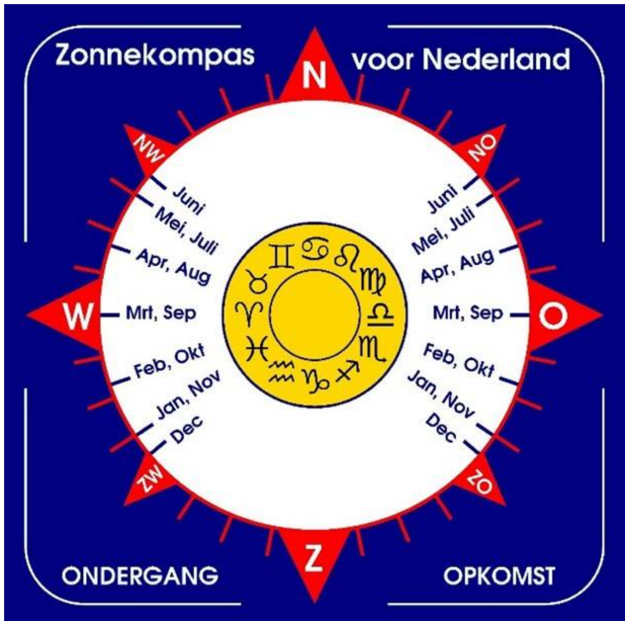
Figuur 11: het zonnekompas voor midden-Nederland, waarvoor als breedtegraad 52° N is genomen. De richtingen waarin de zon opkomt en weer ondergaat zijn gegeven voor de situaties waarin de zon juist in het begin staat van een dierenriemteken. Dat valt op of omstreeks de 21ste van iedere maand. Bron: auteur.
