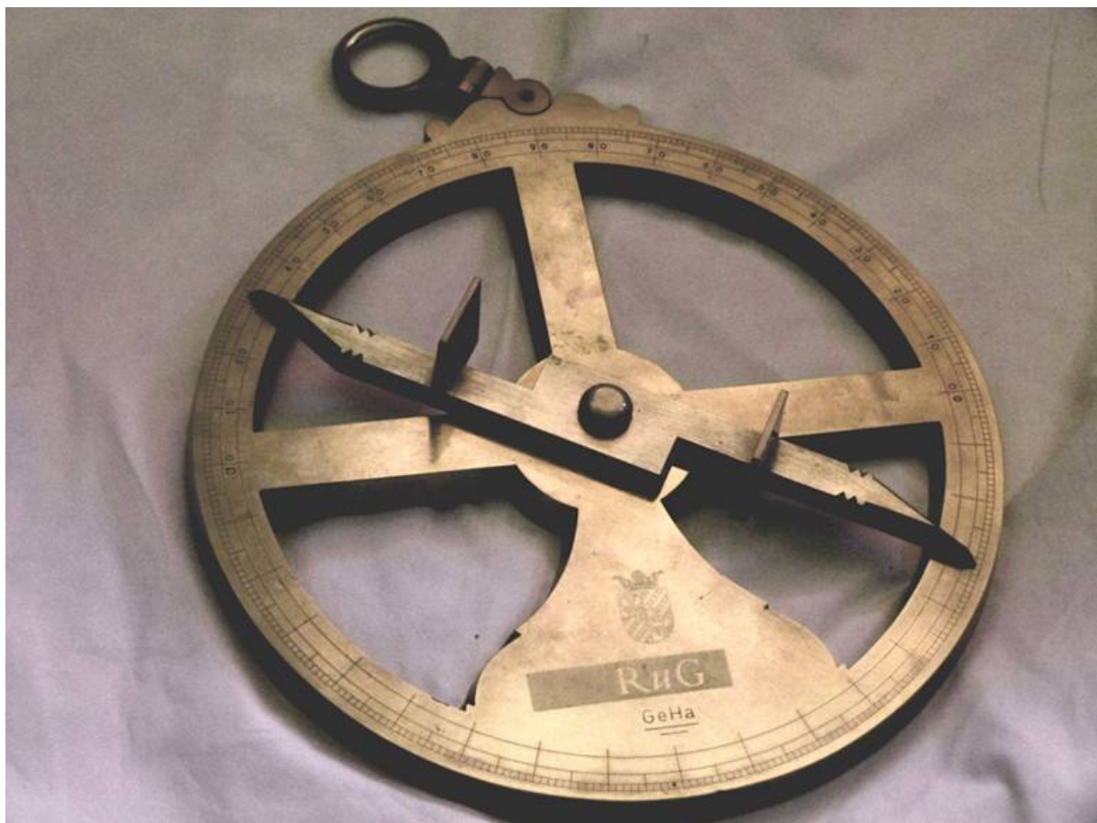
Figuur 9: Replica van een vroeg zeventiende-eeuws astrolabium, de zogenaamde Skokloster-I, afgewerkt in de voormalige sterrenwacht in Roden en voorzien van het wapen en de naam van de Rijksuniversiteit Groningen. Bron: auteur.
